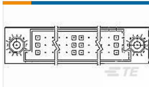
TE 系列/零件编号532447-3 HDI PIN ASSY 3 ROW 96 POS
