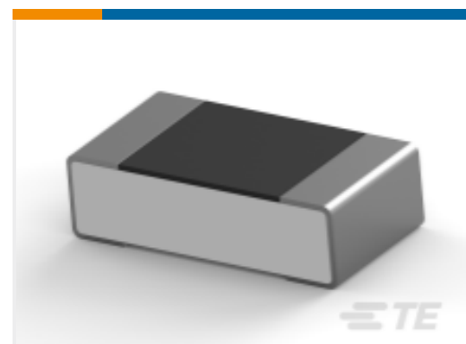
TE 系列/零件编号6-2176370-2 RQ 0603 1K87 0.1% 10PPM 5K RL
