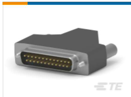
TE 系列/零件编号 1-747948-8 KIT, PLUG, 25P, HDE, SHLD ENCLSRE
