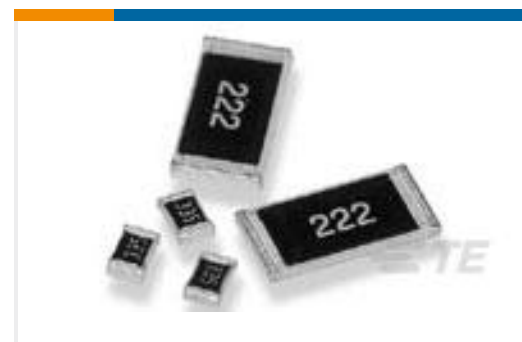
TE 系列/零件编号1623094-1 CRG0603 ZEROHM
