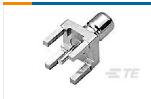
TE 系列/零件编号1- 1337482-0 SMB Str PCB Skt 50Ohm Gold Plt
