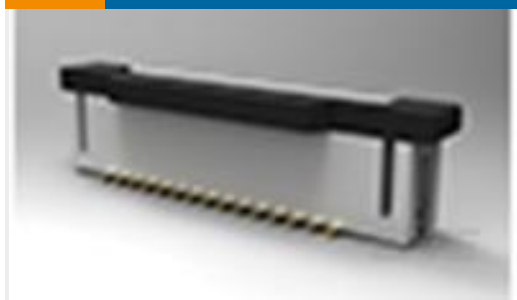
TE 系列/零件编号1-1734248-5 1.0 FPC, ZIF V/T, SMT, 15P
