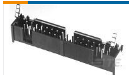
TE 零件编号1761606-9 IDC LOW PRO HDR 26P VERT LG LA
